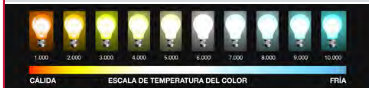
Figura 6.28 Escala Kelvin para medir la temperatura del color.
