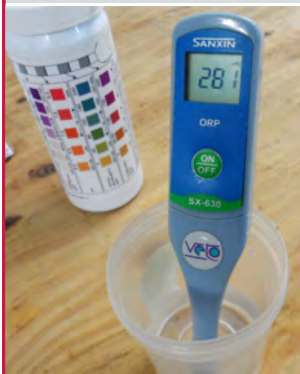
Figura 7.6 Ejemplo de medidor de ORP.
