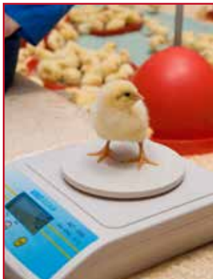
Figura 7.8: Báscula electrónica de plataforma para pesaje individual de aves hasta los 7 días de edad.
