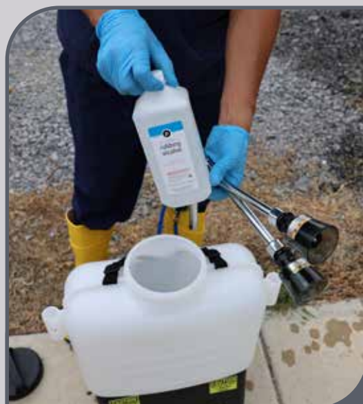
Desinfete o tanque com álcool.
