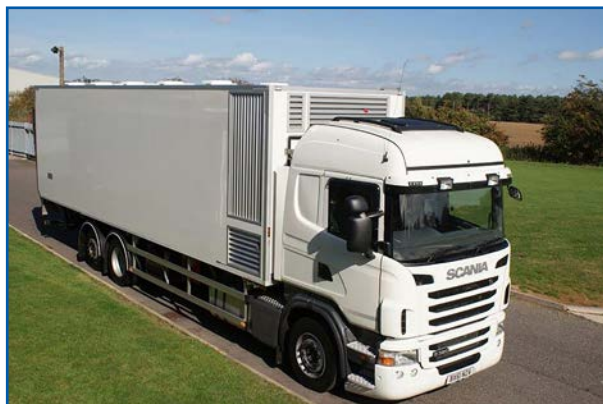
Figura 2.1: Veicolo condizionato per il trasporto dei pulcini.
