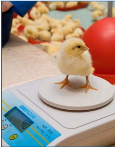
Figura 7.8: Bilancia elettronica per pesate individuali fino a 7 gg.
