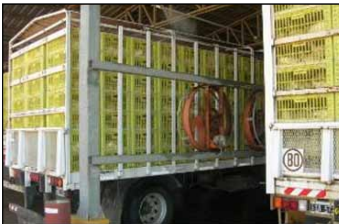
Figure 6: Ventilatori posizionati nella zona di sosta
