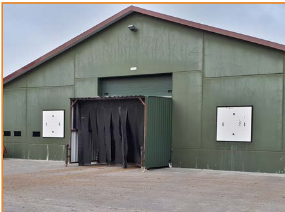
图 8.1: 白天抓鸡时为降低光照强度而使用的卷帘示例。
